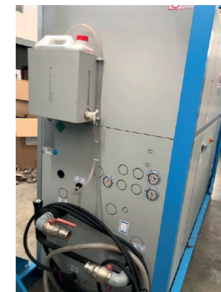
Groupe à eau glacée IPR (vue raccords)
